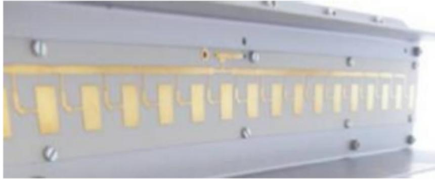
**Figura 2.6. Red de alimentación con configuración serie.**
