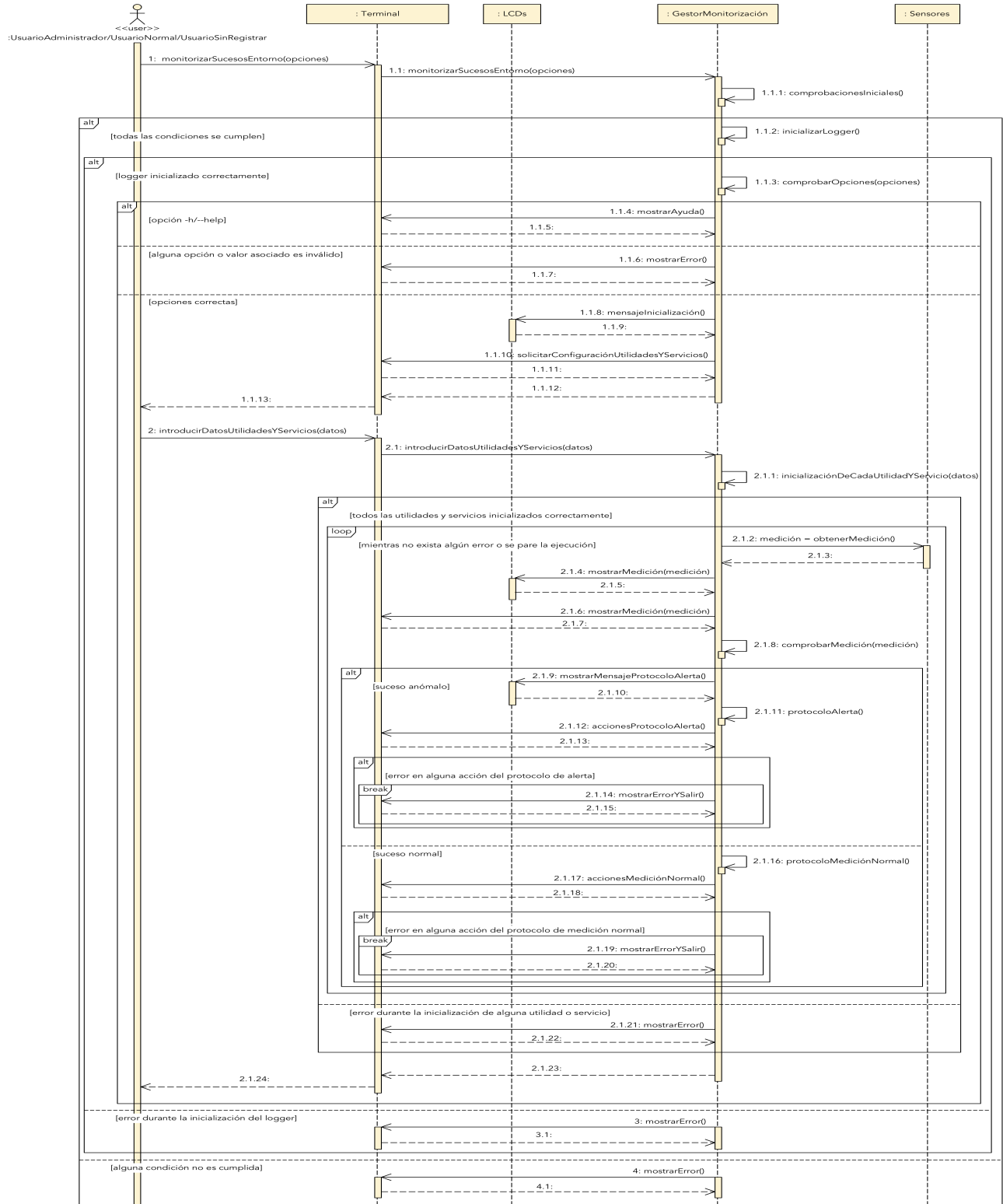
Figura 3.8: Diagrama de secuencia de análisis: Monitorizar sucesos del entorno.
