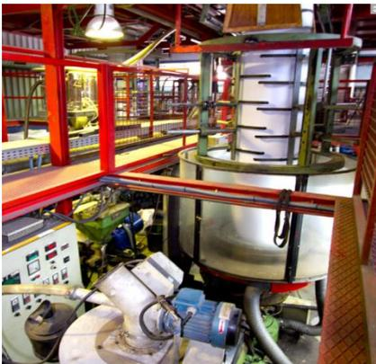
*Imagen 9 Máquina extrusora de la fábrica de G-Innoplast (Innovaciones plásticas SA)
