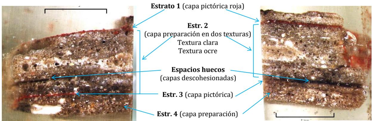
Figs. 13A y B. Imágenes de las muestras PMC\_1, cara A (izq.) y cara B (dcha.)
