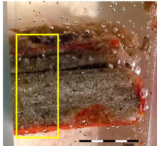
Figs. 15A y B. Arriba, imagen de la muestra 1 (PMC\_1) con la delimitación del área que se ha analizado en SEM. A la izquierda, la imagen del área seleccionada a través del SEM con la referencia numérica y posición de los puntos donde se han realizado los análisis.
