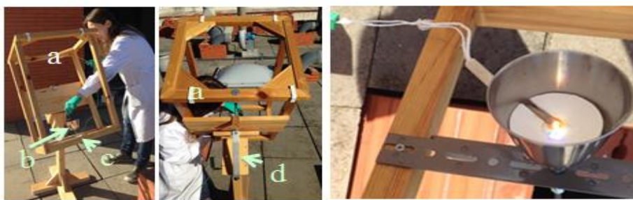
Figura 22. Construcción del reactor solar.
