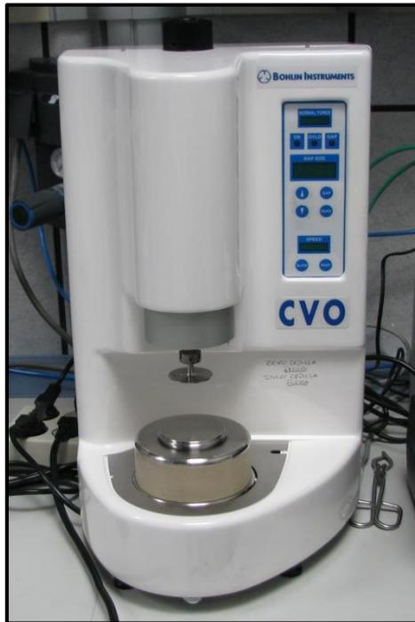
*Figura 3.1. Reómetro Bohlin CVO 100*
