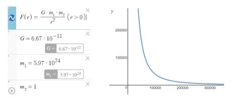
Figura 6. Fuerza gravitatoria para masa de la tierra y objeto de 1Kg, en función de la distancia r entre ambos (elaboración propia en Desmos)
