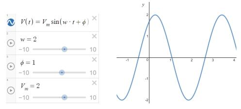
Figura 8. Ejemplo de sinusoide para la tensión en la corriente alterna (elaboración propia en Desmos)
