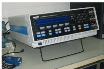
**Figura 11: Equipos utilizados para las medidas de impedancia en AC. (a) Analizador Solatron 1260 (b) ESA Agilent EXA N9019A**
