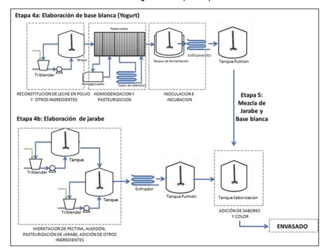
Ilustración 14. Diagramación del proceso productivo
