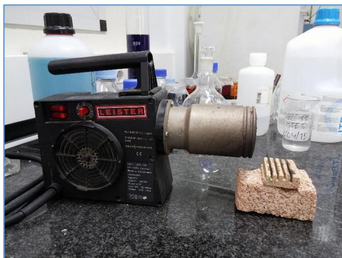
*Figura 2. Dispositivo soplante con seleccionador de temperatura y soporte de colocación de las muestras.*
