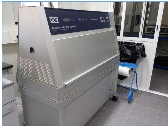
**Figura 3.** Cámara de envejecimiento acelerado Q-lab.
