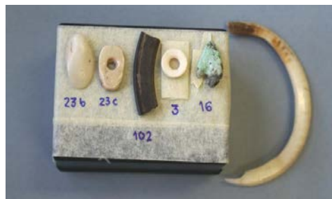
Figura 23- Fotografía de seis de las muestras del yacimiento de Cova Fosca sobre el soporte para el análisis LIBS. (Foto: Gutiérrez, 2010)
