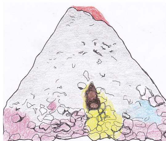
Fig. 200. Valhondo, mapa de deterioro, Oeste Dibujo de la autora
