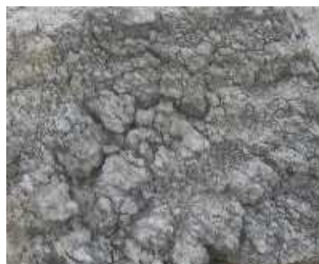
Fig. 162. Meteorización de la piedra de yeso. Fotografía de la autora.
