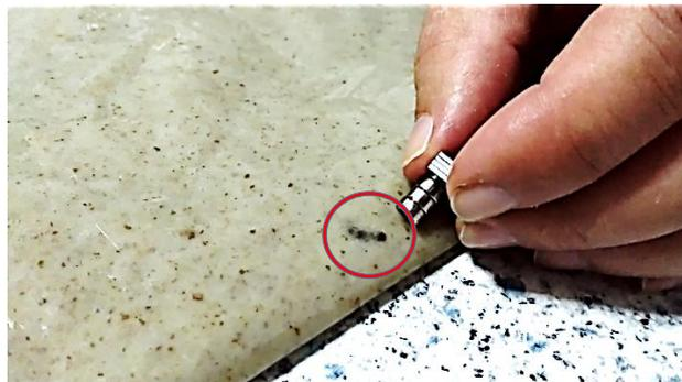
**Imagen 6.** Hierro observado de los cereales triturados en la primera sesión del laboratorio. En la zona redondeada de color rojo se aprecia el hierro acumulado por el efecto del imán de neodimio.
